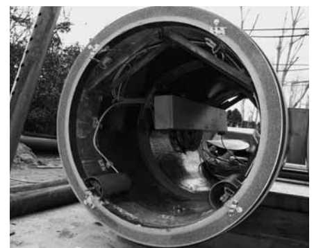
■ Auf Herz und Nieren geprüft: Mit einem ausgeklügelten Messsystem wird die Rohrbelastung beim Rohrvortrieb online überwacht.
